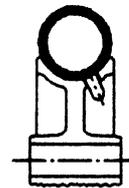
Bild 18: Rad mit Bereifung mit veränderbarem Lufteinschluß
