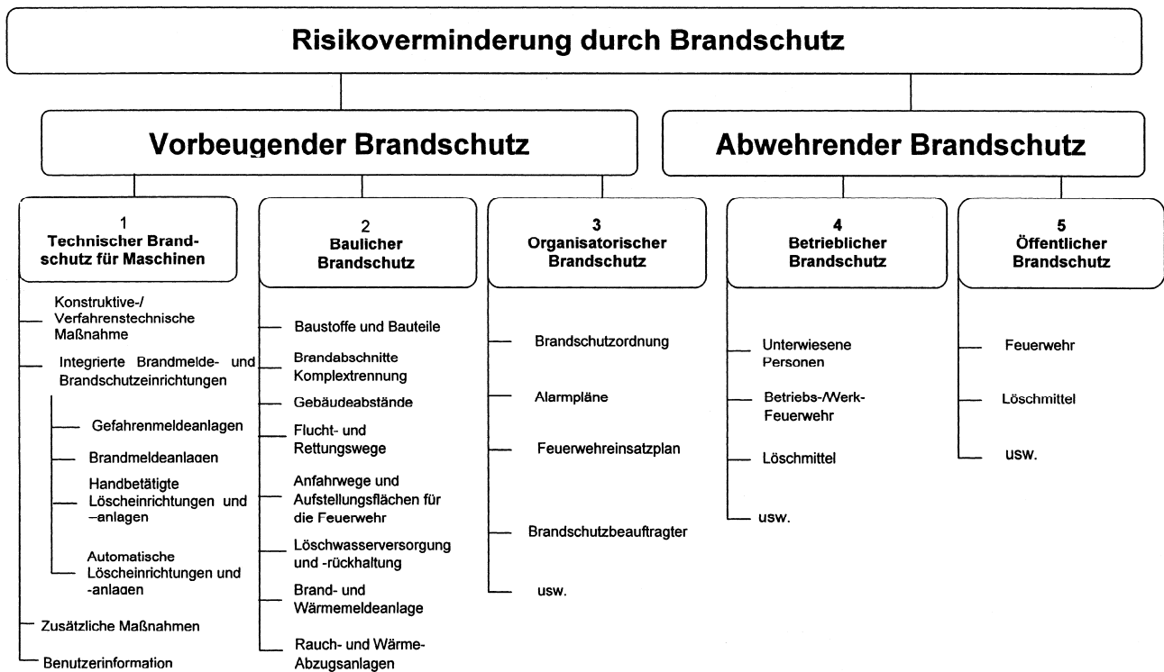
Bild 1 — Risikoverminderung durch Brandschutzmaßnahmen
