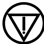
Bild 1 — Symbol (5638) für Not-Halt
