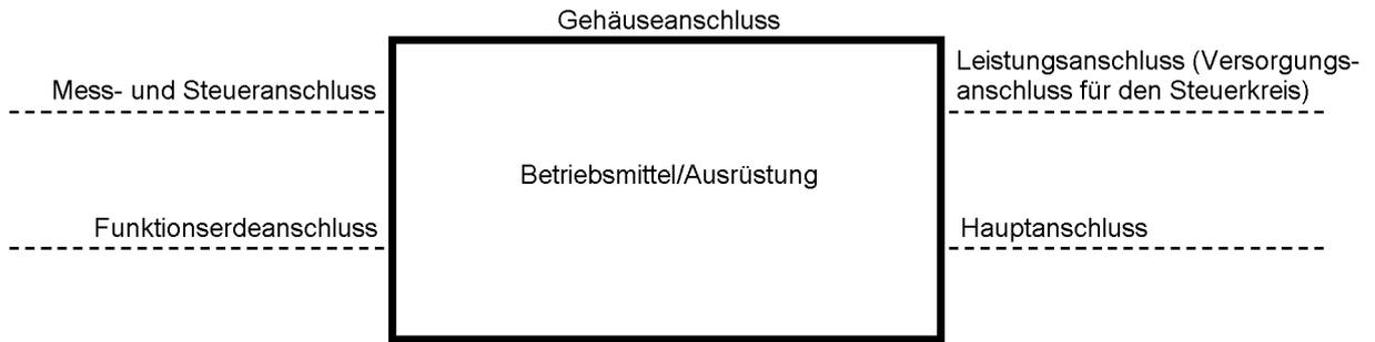
Bild 17 – Beispiele von Anschlüssen
