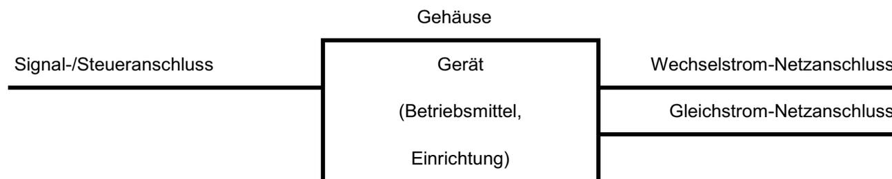
**Bild 1 – Beispiele von Anschlüssen (Toren)**
